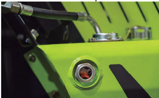
Visor del aceite para comprobar el estado del sistema hidrostático
